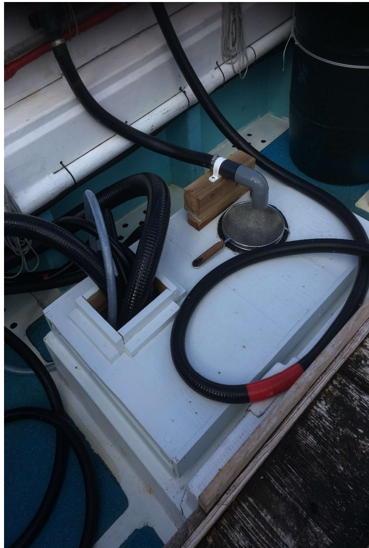
↑ ホースを用いて海水を直接、魚層に取り込む。その際、軽石を網にて除去。
