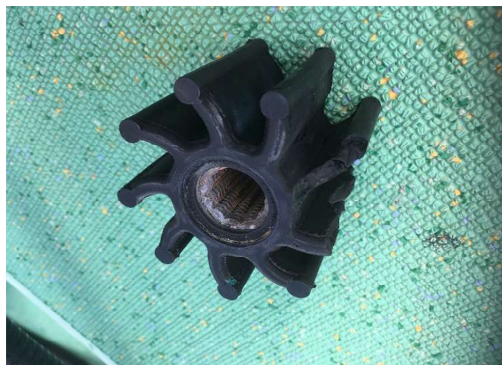
↑インペラの破損
