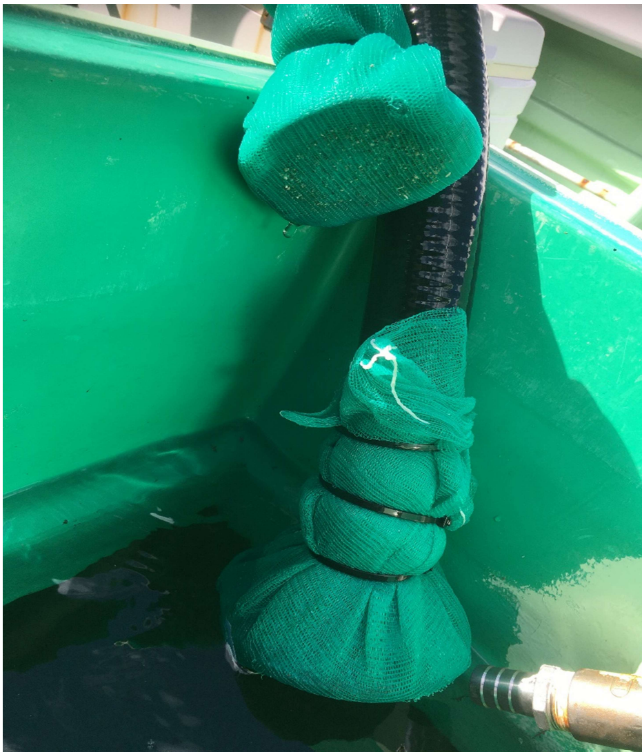
↑魚層の海水をホースで吸い込み、海水を循環させる。吸い込み口で軽石を除去
